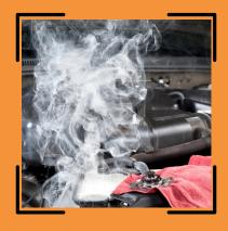
Un loueur constate qu'un des camions de sa flotte, un porteur de 19 tonnes, chauffe anormalement. Il s'adresse au concessionnaire camion. Ce dernier après plusieurs vérifications, prélève un échantillon du liquide de refroidissement. Le fluide présente une couleur bleue et une odeur d'ammoniaque anormales. Il transmet le prélèvement au laboratoire.
