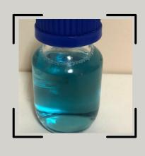
L'analyse du liquide de refroidissement met en évidence une présence alarmante de cuivre et de zinc, provenant certainement d'une attaque de la métallurgie du circuit. La réserve d'alcalinité et le pH anormalement élevés confirment la présence d'un produit corrosif fortement basique (soude, ammoniaque, ...). IESPM alerte sur le fait que tous les éléments métallurgiques du circuit composés de cuivre et zinc sont endommagés à ce stade.
